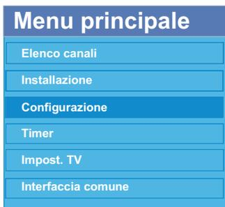
Le diverse funzioni della configurazione sono visualizzate in un elenco, insieme ad una immagine ad un quarto di schermo del canale attualmente selezionato. È possibile selezionare una funzione evidenziando la linea del menu corrispondente con i tasti **▲** o **▼**. Il “Menu Configurazione” (Configuration menu) si presenta come segue:
