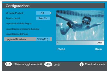
Nel “Menu configurazione” (Configuratio menu), evidenziare “**Aggiornamento ricevitore**” (**Receiver Upgrade**) premendo il tasto ▲ o ▼ e premere “OK” per avviare il processo di aggiornamento. Sullo schermo compare il seguente menu.
