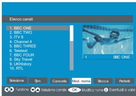
Premendo il tasto ◀ o ▶ ci si sposta al carattere precedente/ successivo. Premendo il tasto ▲ o ▼ si alterna il carattere corrente cioè ‘b’ diventa ‘a’ su ▼ e ‘c’ su ▲. La pressione dei tasti numerici ‘0...9’ sostituisce uno alla volta il carattere evidenziato con quelli stampati al di sopra del tasto.
