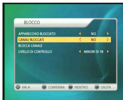
Selezionare CHANNEL TO LOCK (Canale da bloccare) per bloccare un singolo canale. Scegliere i canali da bloccare. Per farlo, scorrere i canali tramite i cursori e premere <OK> ogni volta che si desidera bloccare un canale.
