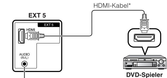
Bei Verwendung eines HDMI-DVI-Adapters/Kabels ist das Audiosignal hier einzugeben.
