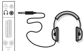
Wenn der Kopfhörer angeschlossen ist, schaltet der Ton des Fernsehgeräts automatisch ab. Mit den Tasten kann die Lautstärke eingestellt werden.
