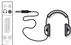
A cuffie collegate, viene eliminato l'audio del televisore. I tasti permettono di regolare il volume.
