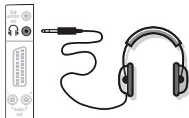
Kun televisioon on kytketty kuulokkeet, televisiosta ei kuulu ääntä. Voit säätää äänenvoimakkuutta näppäimillä .
