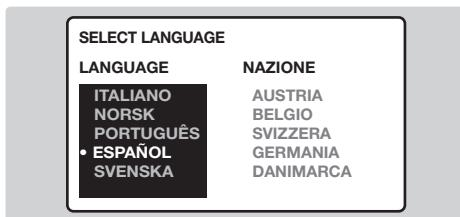
Se il menu non appare, per farlo apparire mantenere premuti per 8 secondi i tasti  $\Delta$  - e  $\Delta$  + del televisore.
