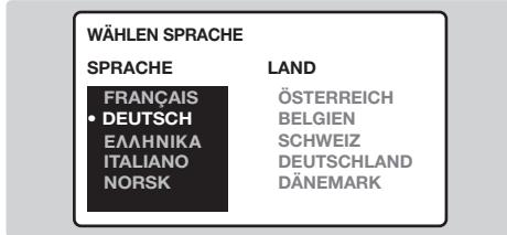
Wird dieses Menü nicht angezeigt, halten Sie die Tasten  $\Delta$ - und  $\Delta$ + des Fernsehgerätes 8 Sekunden lang gedrückt. Das Menü wird hierauf angezeigt.
