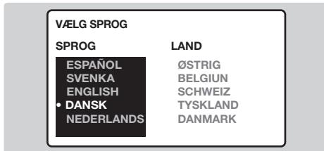
Hvis menuen ikke vises, første gang du tænder fjernsynet, skal du trykke på knapperne  $\Delta$ - og  $\Delta$ + på fjernsynet og holde dem inde i 8 sekunder for at få menuen frem.
