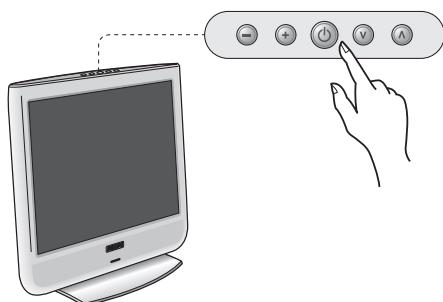
Para encender el televisor, pulse sobre el botón de encendido y apagado. Un indicador se iluminará en color verde y la pantalla se encenderá. Vaya directamente al capítulo **instalación rápida**. Si el televisor está en espera (indicador rojo), pulse el botón P (+) del mando a distancia.
