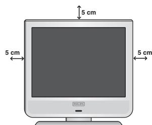
Plaats uw toestel op een stevig en stabiel vlak. Stel het toestel nooit bloot aan waterspatten, warmtebronnen (lamp, kaars, radiator,...) en houd de ventilatieroosters achteraan het toestel vrij.
