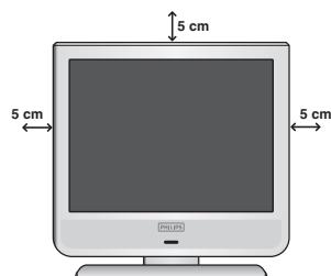
Stellen Sie das Fernsehgerät auf eine stabile Unterlage. Um Gefahren zu vermeiden, achten Sie darauf, dass das Fernsehgerät nicht in Kontakt mit Wasser kommt. Außerdem dürfen sich keine Wärme abstrahlenden Gegenstände (z. B. Lampen, Kerzen, Heizkörper) in unmittelbarer Nähe des Geräts befinden. Achten Sie darauf, dass die Lüftungsschlitz auf der Rückseite immer frei bleiben.
