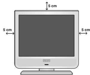
Coloque el televisor sobre una superficie sólida y estable. Para prevenir las situaciones peligrosas, no exponga el televisor a salpicaduras de agua ni a una fuente de calor (lámpara, vela, radiador, ...) y no obstruya las ranuras de ventilación situadas en la parte posterior.
