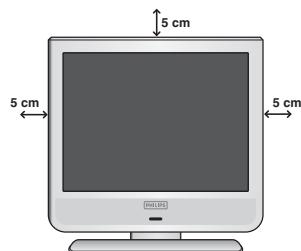
Plasser TV-apparatet på en solid, stabil flate. For å forebygge farer må du unngå å utsette TV-apparatet for vannsprut eller varmekilder (lampe, stearinlys, radiator osv.) og ikke tette til ventilasjonsristene bak på apparatet.
