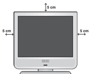
Τοποθετήστε την τηλεόρασή σας σε μία Στέρετη και σταθερή επιφάνεια. Για να προλάβετε τυχόν επικινδυνες καταστάσεις, μην εκθέτετε την τηλεόραση σε νερό, σε μία πηγή θερμότητας (λάμπα, κερί, καλοριφέρ, ...) και μην εμποδίζετε τα ανοίγματα θυρίδες εξαερισμού που βρίσκονται στην πίσω όψη.
