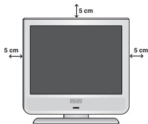
Coloque o seu televisor numa superfície sólida e estável. Para evitar qualquer situação perigosa, não exponha o televisor a projecções de água, a uma fonte de calor (candeeiro, vela, radiador,...) e não tape as grelhas de ventilação que se situam na retaguarda.
